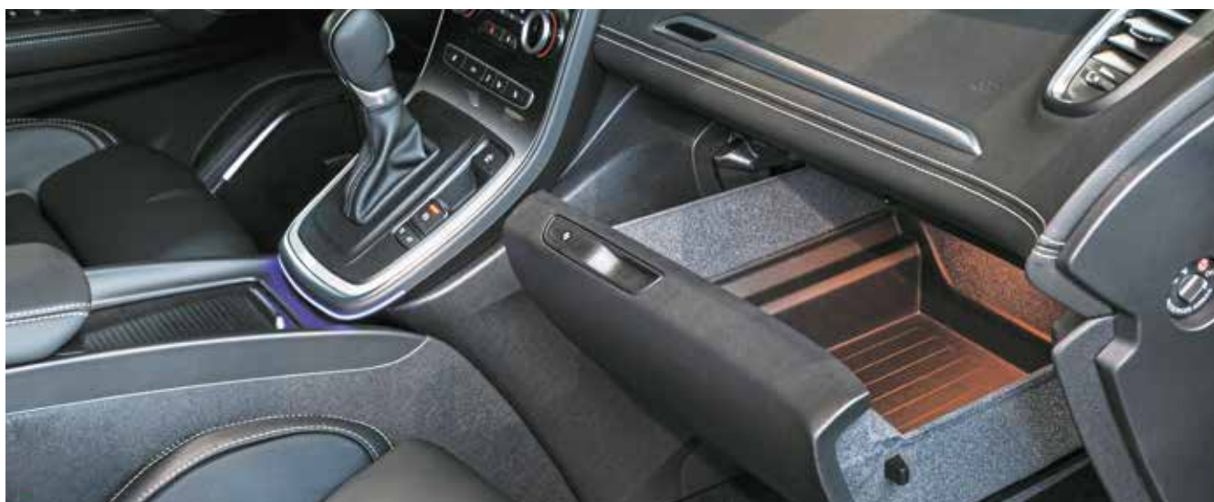
Das Handschuhfach bis in die hinterste Ecke nutzen: Möglich machen das lineare Auszugssysteme.
