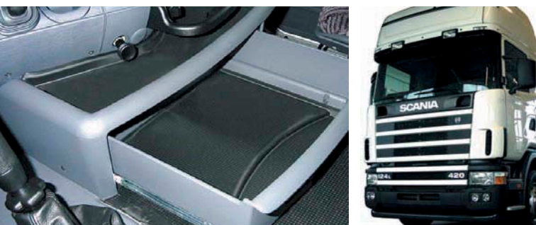
Scania. Vano portaoggetti con bloccaggio. Il funzione di bloccaggio della guida evita la chiusura accidentale del vano portaoggetti aperto.
