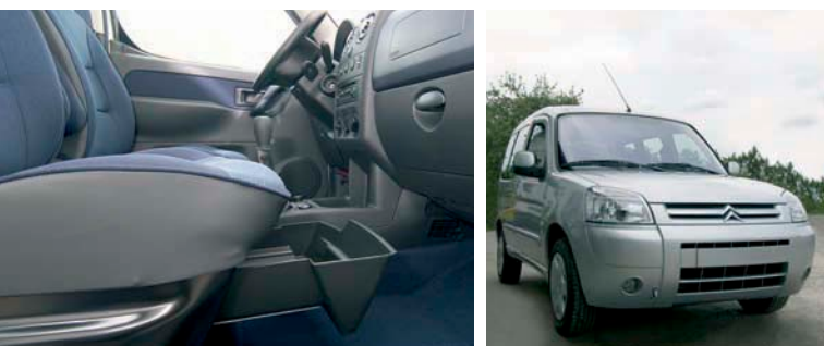
Citroën. Montaggio a basso ingombro. La guida del cassetto del sedile del Minivan abbina un movimento perfettamente scorrevole con un utilizzo intelligente dello spazio disponibile.
